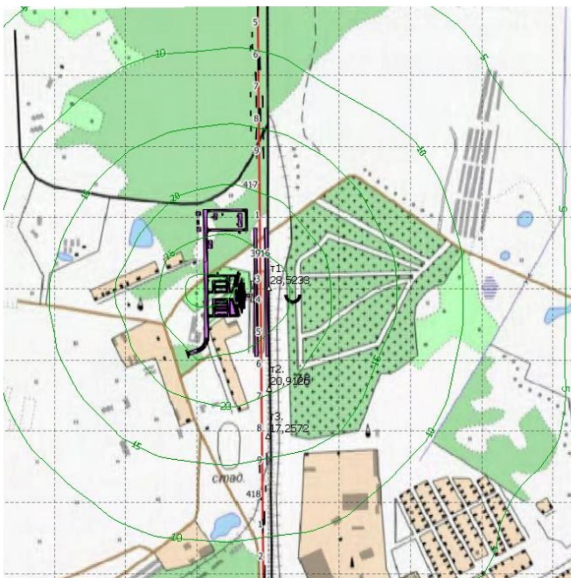
Рисунок 2.4 Схема распространения шума от раздельного пункта (на примере станции «Аэропорт»)
